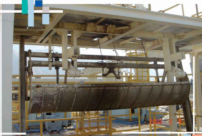
سیستم جمع آوری زباله از یک سیستم الکترومکانیکی جهت بالا و
